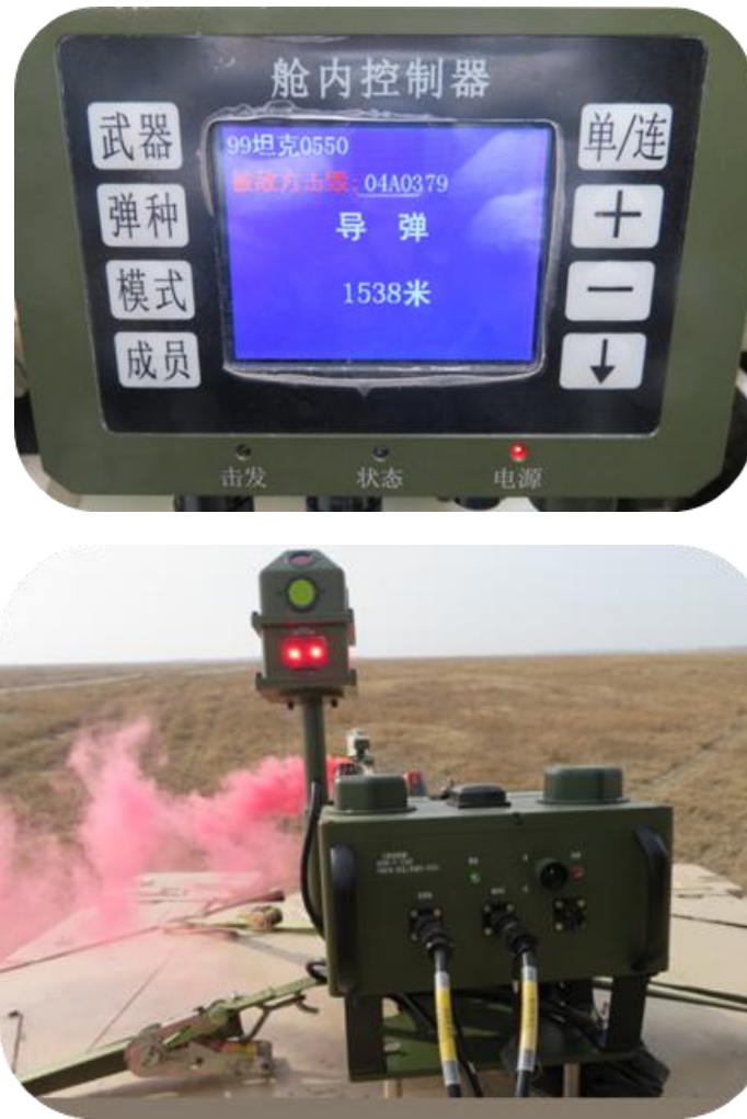
图 2-6 装甲类模拟器材被毁伤后烟雾、灯光及舱内机显示
