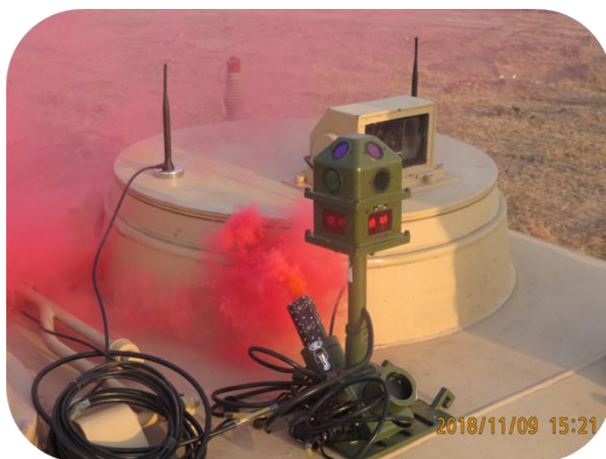
图 2-12 火炮模拟器材安装图及被毁伤后烟雾显示效果
